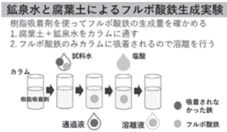
図4 フルボ酸鉄形成確認実験概要
