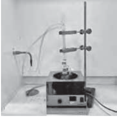
図 2. PET 微粒子調製に用いた加熱還流装置
