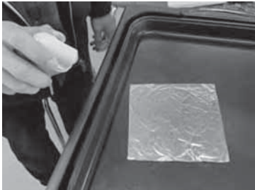
図13 スチーム吸入器を用いて金水溶液をミスト状にして金めっきおよび加熱をする様子
