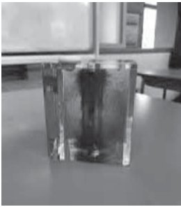
図1. 既存の磁力線を立体的に観察する方法。油で満たした容器に砂鉄を混ぜ、その中に磁石を入れるが、観察範囲は狭く、1台25,000円と高価である。
