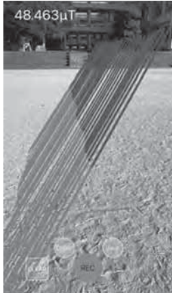
図3. 屋外での地磁気の測定結果。円柱の長さ方向が磁気を表す。均一な地磁気が地面に刺さるように分布している様子が分かる。
