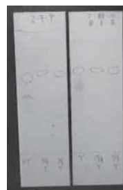
図11 実験11 スポットD・E・Fを用いた検定結果 展開溶媒 (右: 1-ブタノール: 酢酸: 水 8:3:2v/v 左: 1-ブタノール: エタノール: アンモニア水 2:1:1v/v) スポットDを含むF5~9に強い成長抑制作用が見られた。
