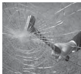
＜写真6＞ ハンマーでガラスにひびが入った様子
