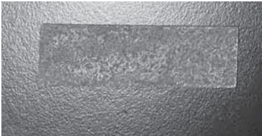
【図 1】鉄サビのモデル 20×70×1 mm の鉄板を塩酸と過酸化水素水の混合液に 1 分間浸して急速に酸化させたもの。
