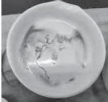
図13 サンプルBの層を加熱したもの
