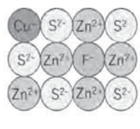
図 10. \text{Cu}^+ と \text{F}^- を取り込んだ \text{ZnS} の模式図
