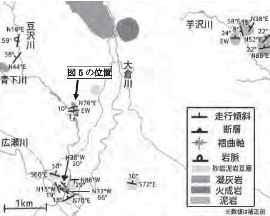
図3 調査範囲におけるルートマップ。本調査により記録した岩相分布と地層の走向傾斜を示す。
