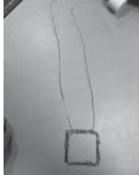
図 3 自作した銅のコイルのブランコ
