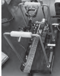
図 2 コイルのブランコを掛けた支柱 (スイッチを入れることで、電流を ON/OFF できる。)
