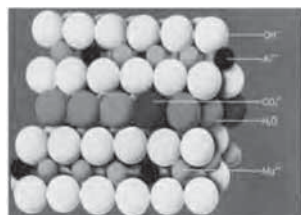
図3 ハイドロタルサイトの構造 (写真提供: セトラスホールディングス)
