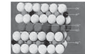
図4 ハイドロタルサイトの構造模式図 (写真提供: 協和化学工業株式会社)
